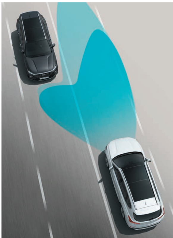
Автоматическое переключение дальнего/ближнего света. Автоматически переключает дальний или ближний свет фар в соответствии с дорожными условиями.
