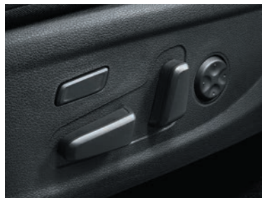
Сиденье водителя с электрорегулировкой в 14 направлениях.
