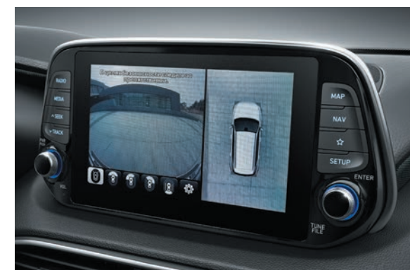
Система слежения за состоянием водителя. Анализирует поведение водителя во время движения и предупреждает о необходимости остановки для отдыха. Система кругового обзора. Система из 4 камер обеспечивает отличный обзор, помогая водителю во время парковки.
